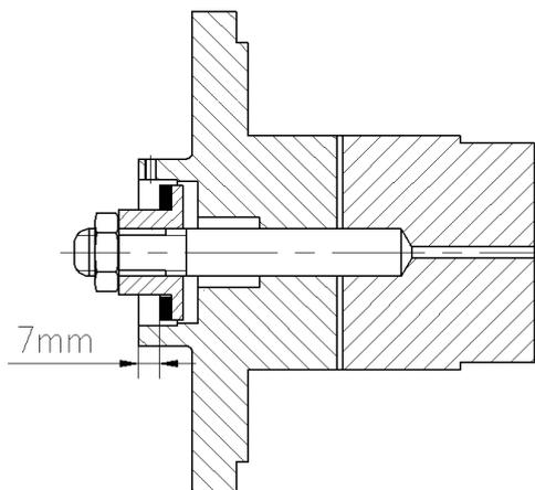
2. 根据记号笔标识和钢皮尺测量尺寸按拆前的位置复原顶帽，用锁紧片和螺钉 M4×8 紧固。
