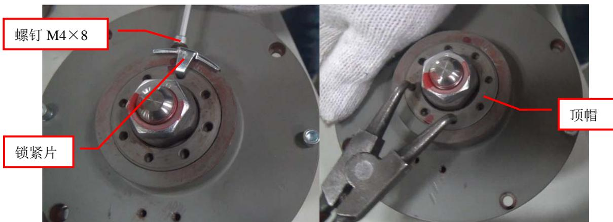
7. 用开口扳手（24mm）拧出螺母 M16×1.5 和撞套，分离动静铁芯组件。
