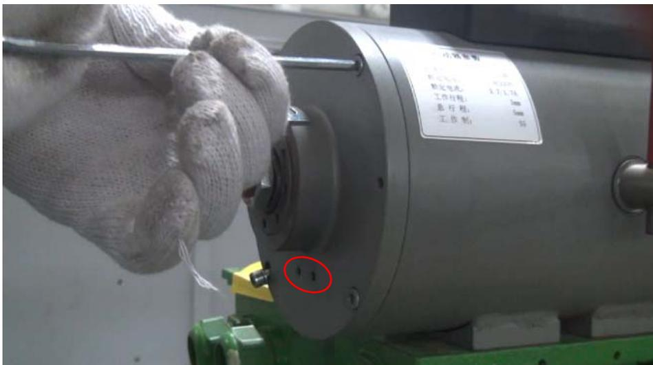
4. 将微动开关支架（包括微动开关）装上制动器静铁芯，用两件螺钉 M4 紧固。
