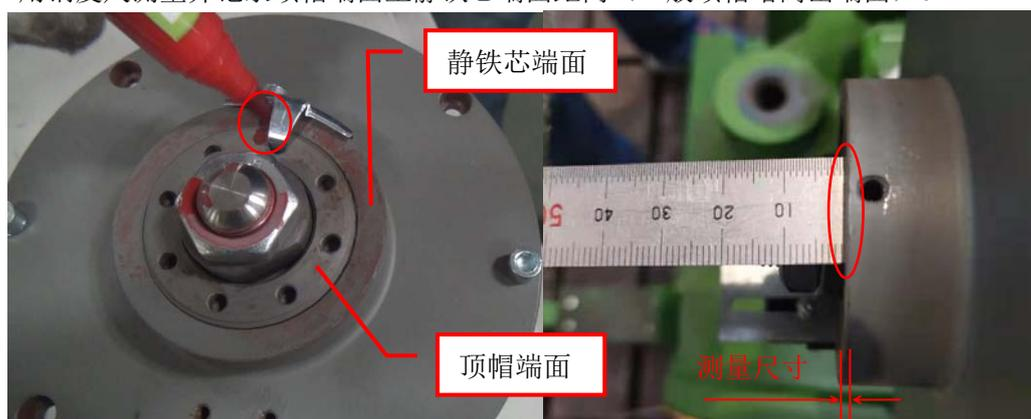
6. 用内六角扳手（3mm）拧出螺钉 M4×8，拆下锁紧片，用卡簧钳拧出顶帽。
