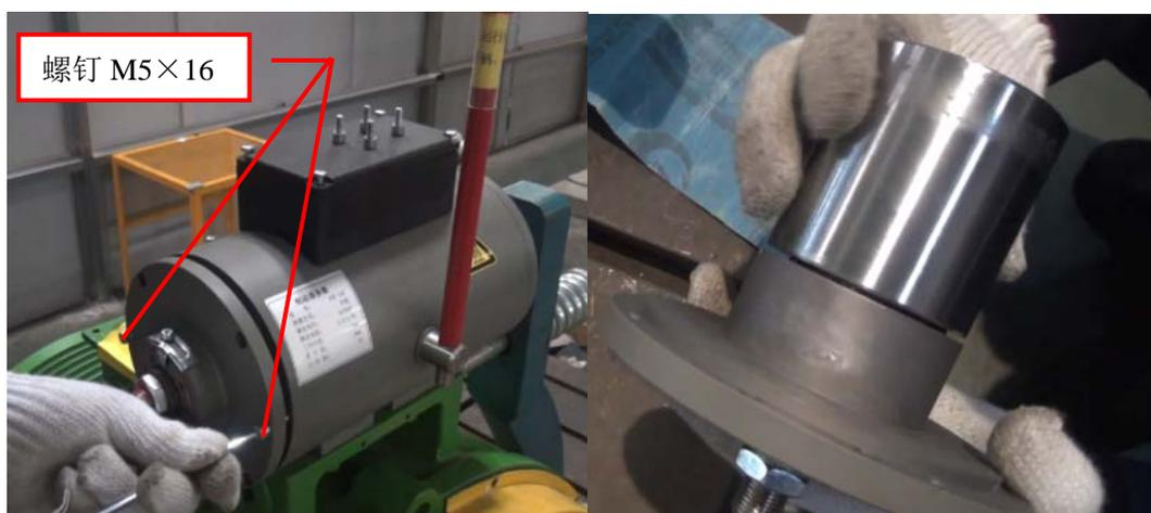
5. 用记号笔在顶帽和静铁芯端面处（锁紧片旁边，图示位置）做上标记（以便后续复原），用钢皮尺测量并记录顶帽端面至静铁芯端面距离（一般顶帽略高出端面）。
