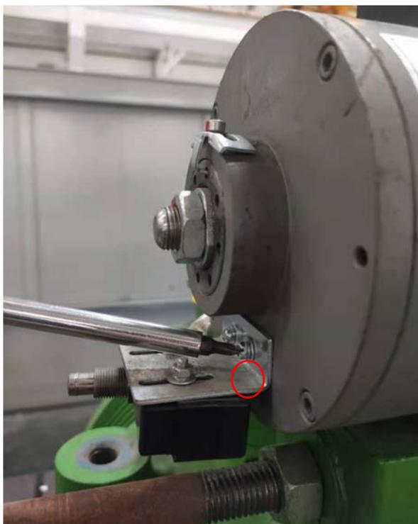
3. 用内六角扳手（4mm）松开固定静铁芯的四件螺钉 M5。
