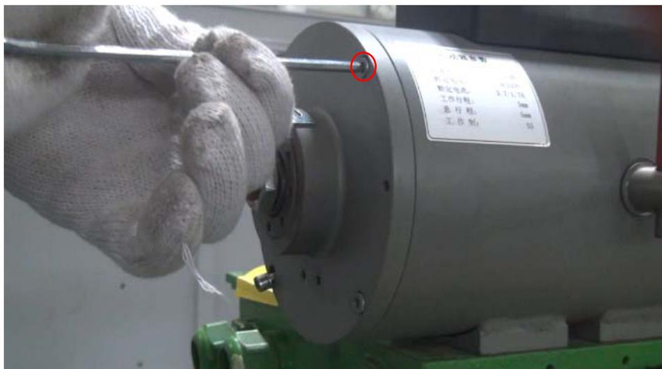
4. 在静铁芯拆卸孔拧入两件螺钉 M5×16，将动静铁芯组件顶出。
