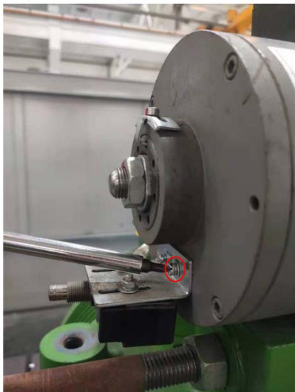
5. 按照标识将双头螺栓和制动臂复原（参照安装制动瓦方法）。
